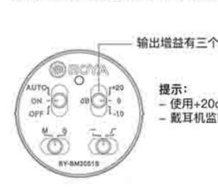
使用+20dB增益功能最大程度地增强麦克风的收音效果。戴耳机监听设置音量时,可能会产生爆破声。
